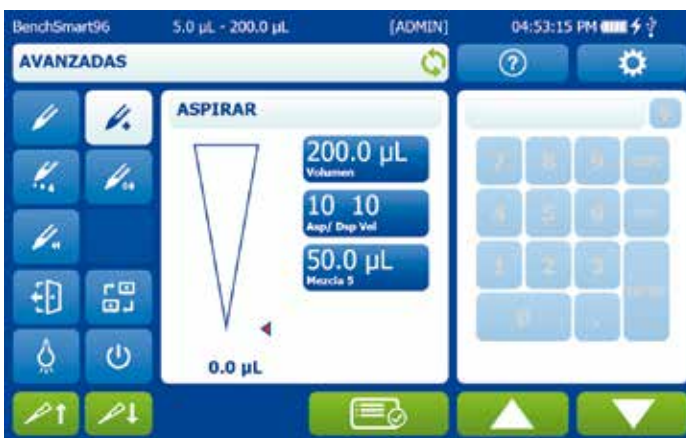
Figura 3-9: Configuración de parámetros de mezcla
