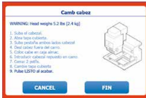
Figura 1-22: Secuencia de carga del cabezal
