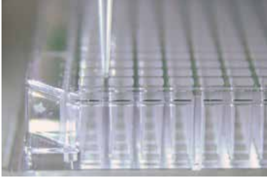
Figura A-7: Ubicación correcta de la punta entre los cuatro pocillos de la esquina frontal izquierda de la placa
