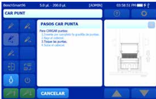
Figura 2-4: Secuencia de carga de puntas
