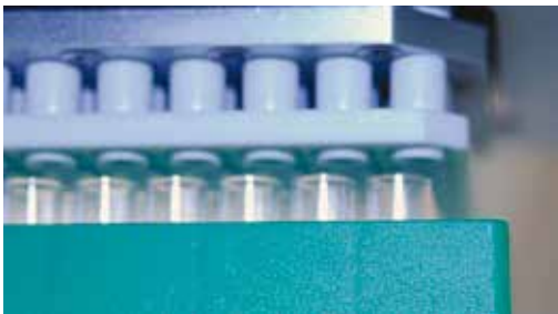
Figura A-2: Boquillas mal alineadas (ejemplo exagerado)
