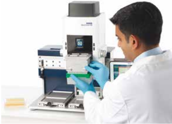
Figura 1-21: Uso de una gradilla vacía como soporte del cabezal para pipetas
