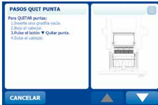
Figura 2-10: Secuencia de expulsión de puntas
