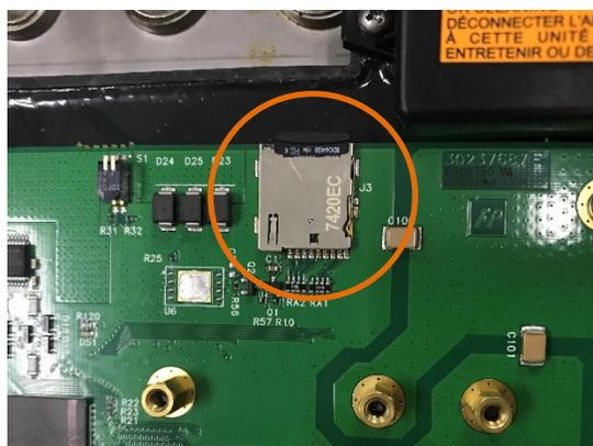
**Figura 3-46: Ubicación de la tarjeta SD del IND256x**
