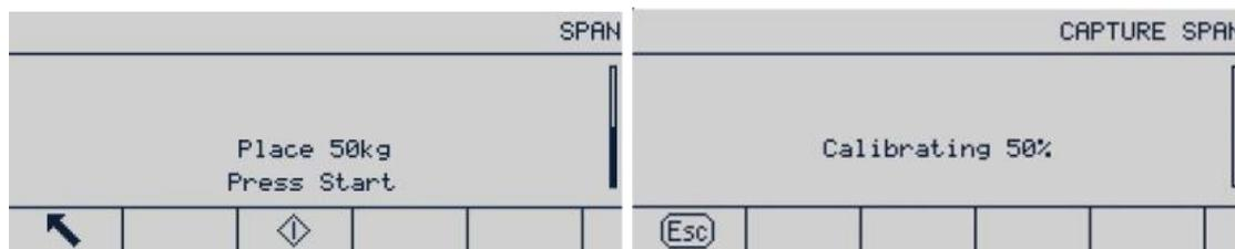
**Figura 3-15: Calibración de extensión en progreso**
