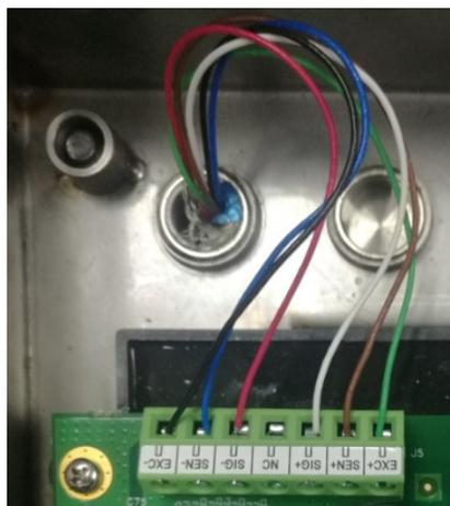
Figura 4-3: Terminal de conexión de celda de carga analógica
