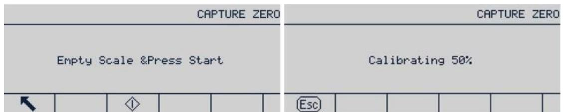
**Figura 3-11: Calibración de cero**
