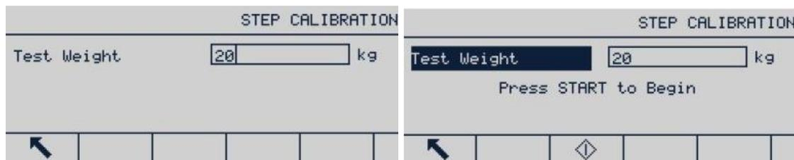
**Figura 3-22: Ingreso del valor del peso de prueba**
