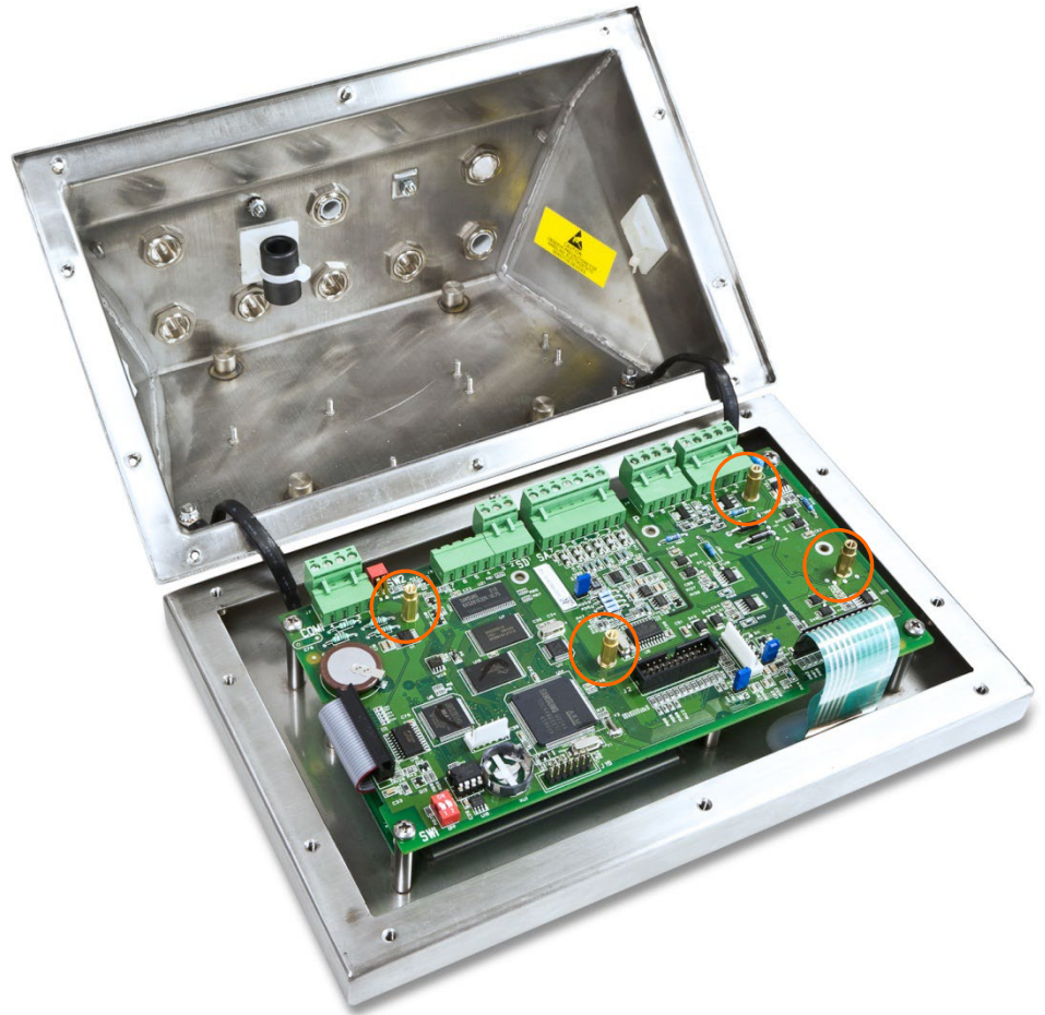
Figura 3-27: Posizionamento dei distanziatori in ottone dell'IND560x-PAB
