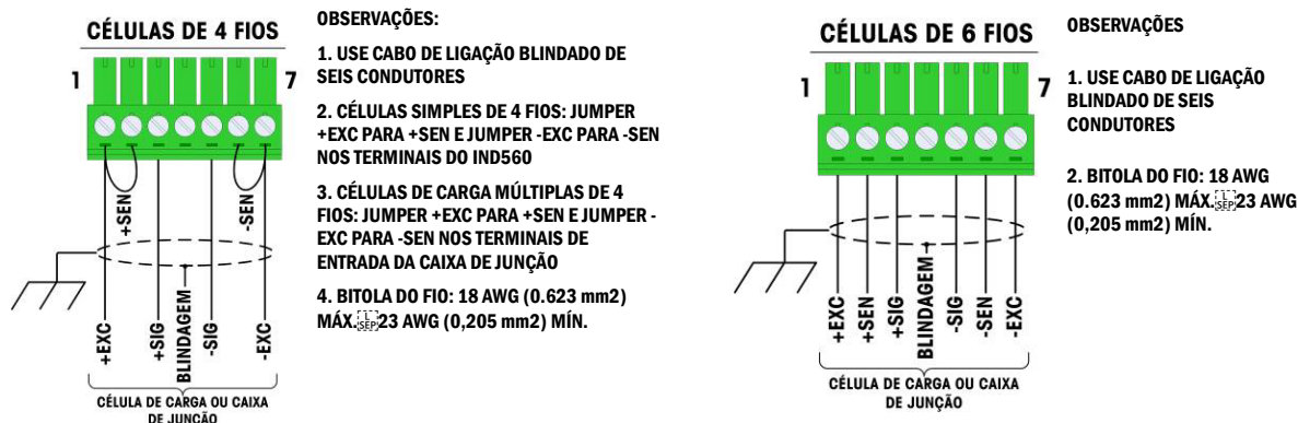
Figura 3-21: Terminação da célula de carga
