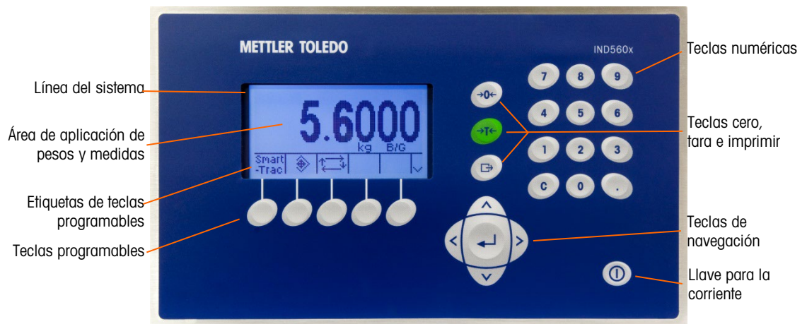
Figura 1-9: Pantalla y distribución del teclado del IND560x
