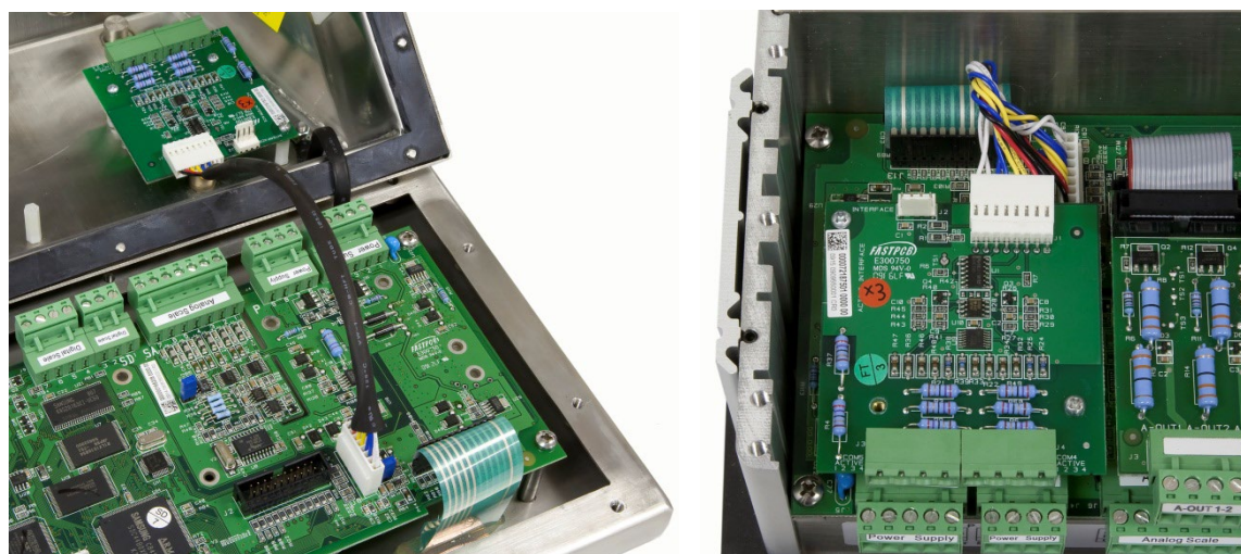
Abbildung 3-41: Eigensichere Stromschleifenschnittstellenplatine – Raue Umgebung (links) und Schalttafeleinbau (rechts)
