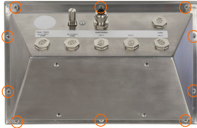
Abbildung 3-3: Schrauben für die Vorderplatte
