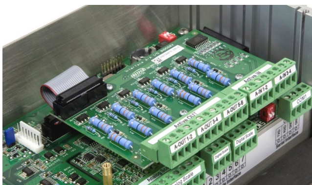
Abbildung 3-36: Installation des diskreten I/O am Gehäuse für den Schalttafeleinbau
