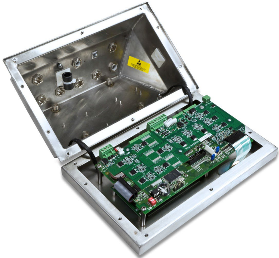
Figura 3-28: PAB instalada en la tarjeta principal del IND560x
