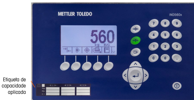
Figura 3-52: Etiqueta de capacidade instalada
