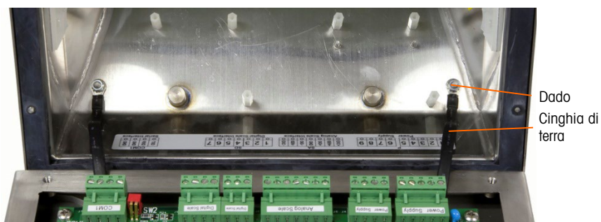
Figura 3-11: allentamento delle cinghie di terra
