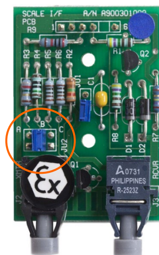
Figura 3-43: Posizione del pin J2 sul PCB opzionale FO di Puma/ID3sTx
