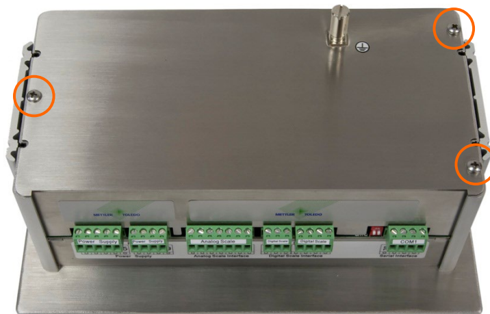
Figure 3-2: Ouverture de la version montage sur panneau
