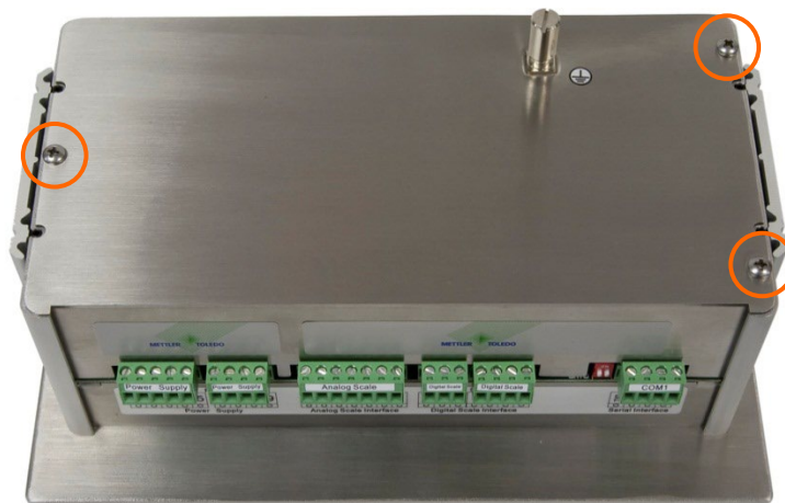
Abbildung 3-2: Öffnen des Gehäuses für den Schalttafeleinbau
