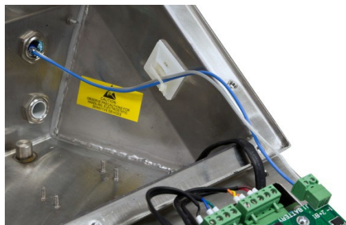
Figura 3-32: Conector del paquete de batería de la PAB (izquierda) e instalación del cable de la batería
