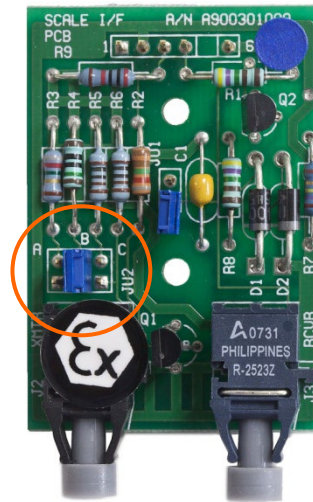
Abbildung 3-43: J2-Stiftposition auf der LWL-Optionsplatine des Puma/ID3sTx-Terminals
