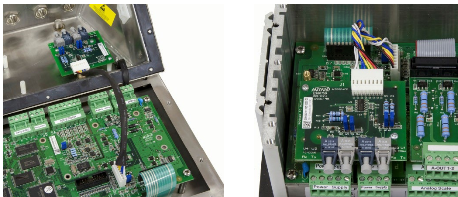
Figura 3-42: Tarjeta de interfase de fibra óptica
