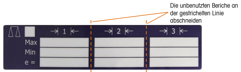
Abbildung 3-51: Vorbereiten des Kapazitätsaufklebers
