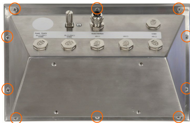
Figura 3-3: Viti pannello anteriore
