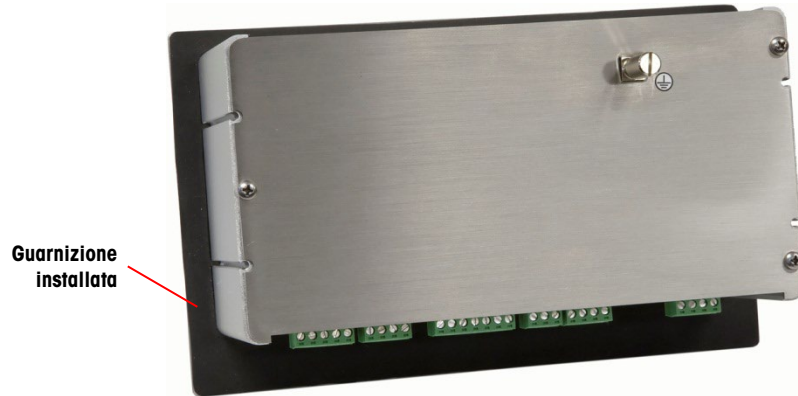
Figura 3-6: Guarnizione pannello anteriore installata
