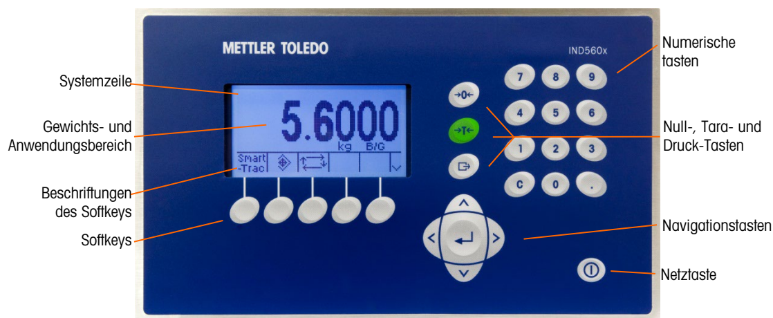
Abbildung 1-9: Anzeige und Tastaturlayout des IND560x
