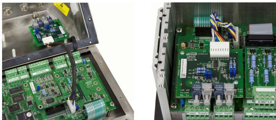
Figure 3-42: Carte de l'interface à fibres optiques
