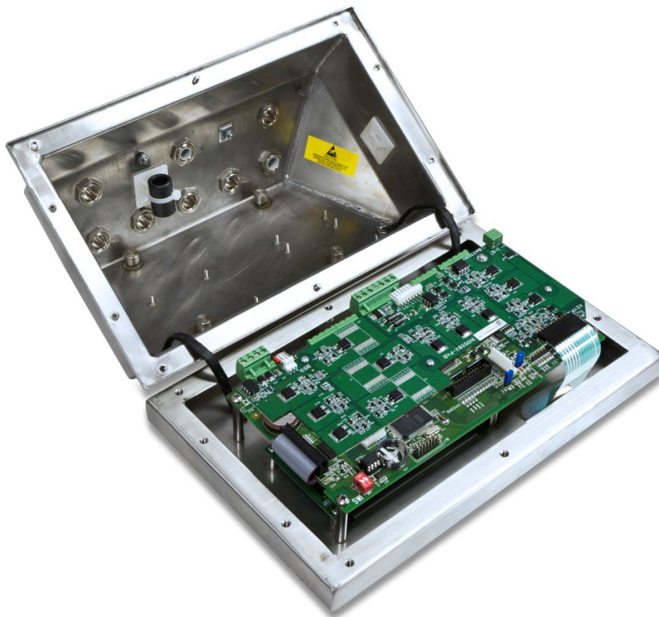
Figura 3-28: PAB installata sulla scheda madre del terminale IND560x
