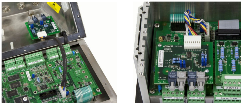
Figura 3-42: Scheda di interfaccia a fibra ottica
