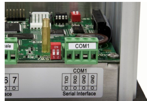
Abbildung 3-47: Positionen von SW1 (links) und SW2 (rechts)
