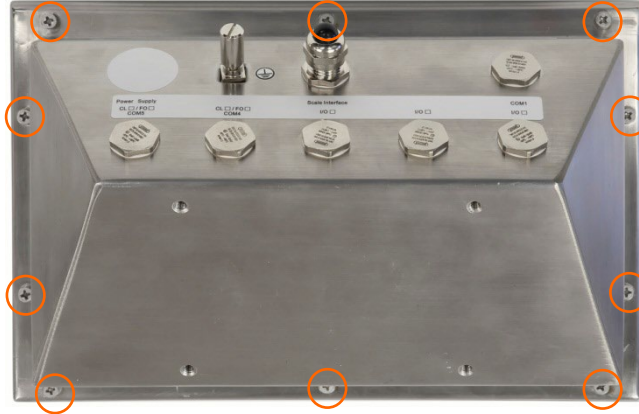
Figura 3-3: Tornillos del panel frontal
