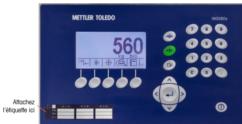
Figure 3-52 : Étiquette de capacité installée
