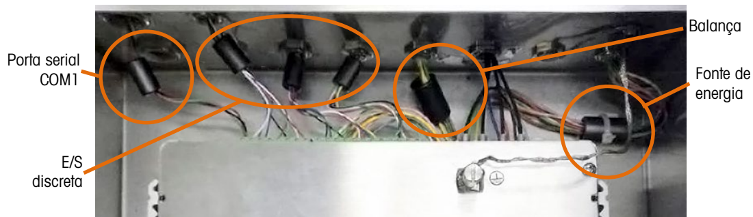
Figura 3-15: Ferrites para Instalação do Painel SICSPRO
