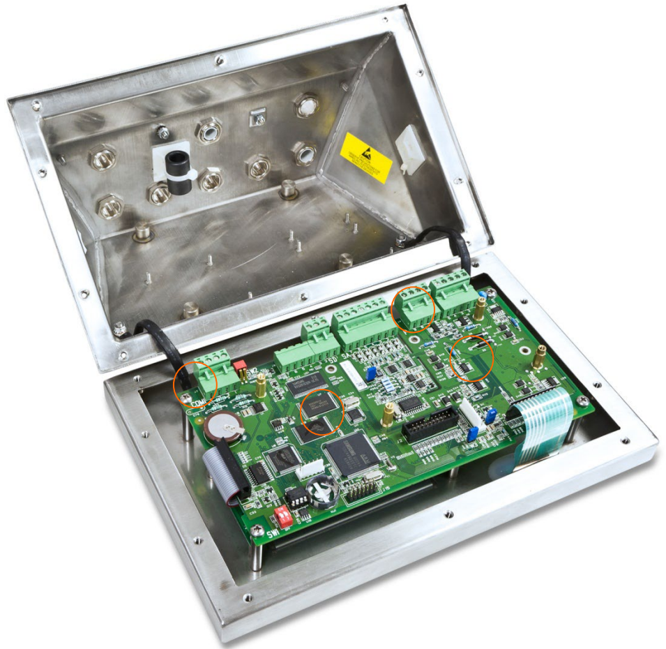
Abbildung 3-27: Position der IND560x-PAB-Abstandsstücke aus Messing
