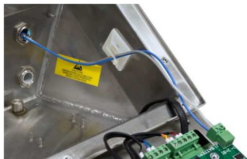
Abbildung 3-32: PAB-Akkupack-Verbinder (links) und Installation des Akkukabels
