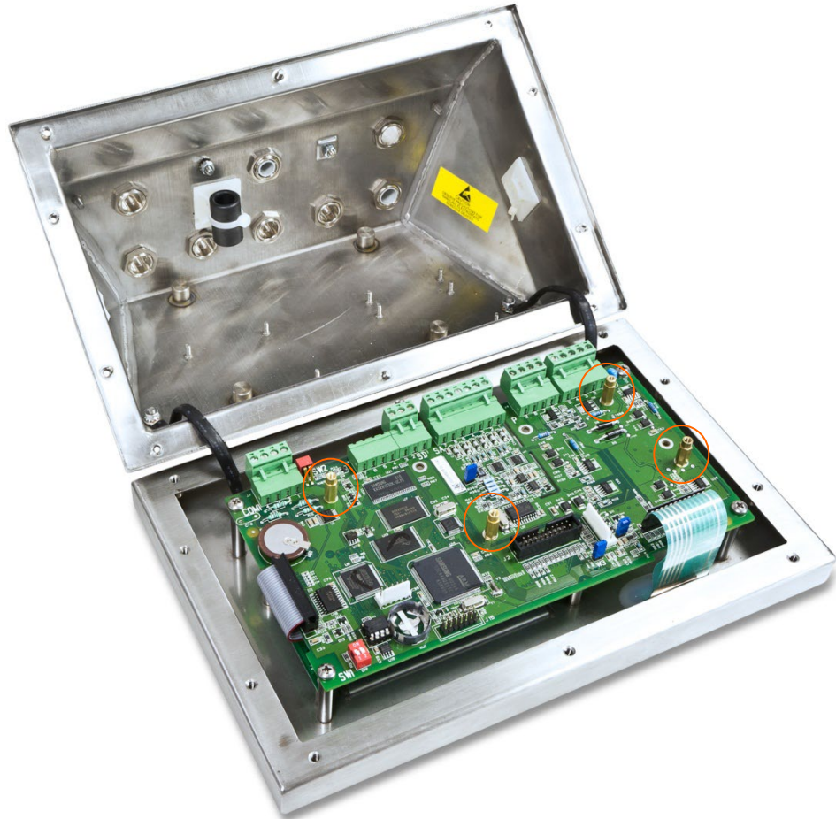
Figure 3-27 : Emplacement des supports en laiton de l'IND560x
