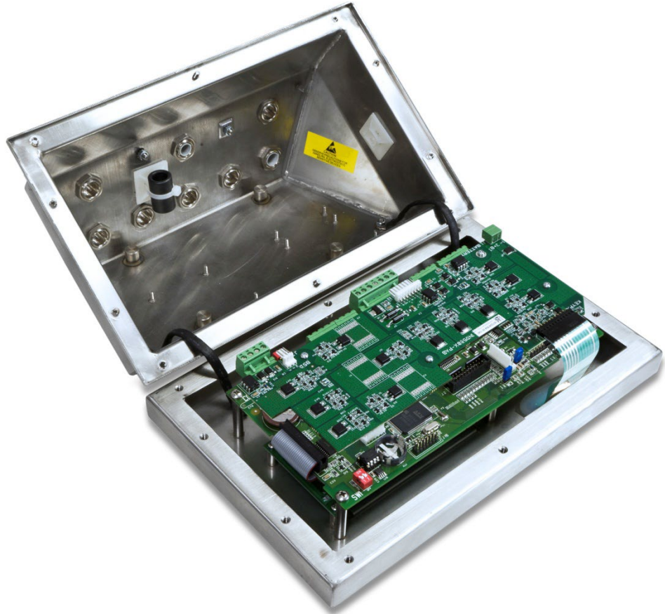
Abbildung 3-28: Stromadapterplatine (PAB) auf IND560x-Hauptplatine installiert
